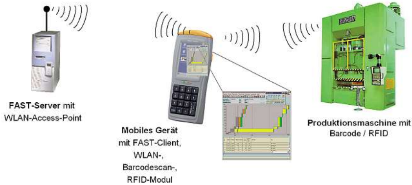
Bild 1: Schematische Darstellung des Funktionsprinzips des Mobitep-Projektes.
